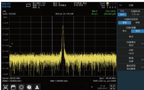
波形扫描点数高达10001, 波形显示更细腻, 分辨率更高, 测量幅度和频率结果更准确
